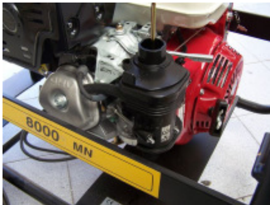
3.-Desmontamos el filtro de aire, quitando las 2 palometas de la tapadera y filtro, así como los 3 tornillos que sujetan la carcasa del filtro, 2 delante y uno en la parte superior
