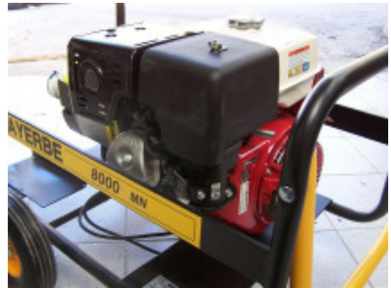
2.-Nuestra víctima: en este caso.. Un Honda GX390 de 13CV con arranque eléctrico..
