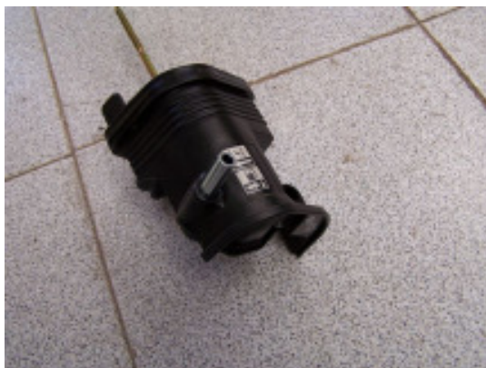
5.- Retiramos los casquillos de hierro de la carcasa. (según modelo de generador hay que agrandarlos con un taladro)
