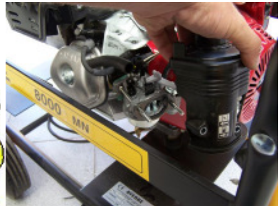
4.- Retiramos la carcasa con cuidado procurando que no se rompa la junta negra entre carburador y filtro, dejandola pegado al carburador
